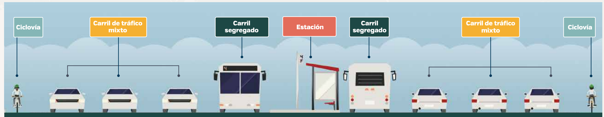
Esquema del perfil vial en una estación tipo del sistema BRT, tomada de blog.tstc.org
